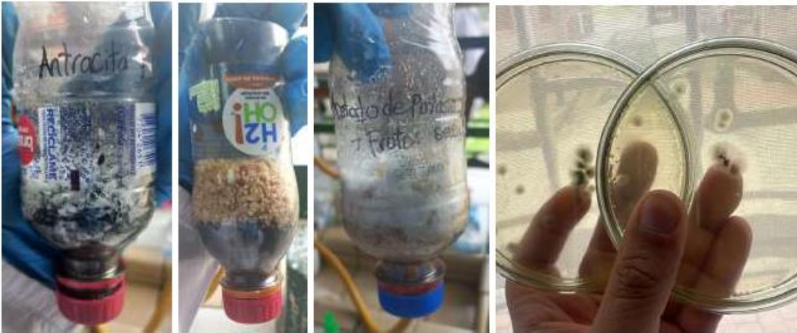
Figura 1. Filtros con antracita, frutos secos y hongo Aspergillus Niger para la remoción d Arsénico en aguas
