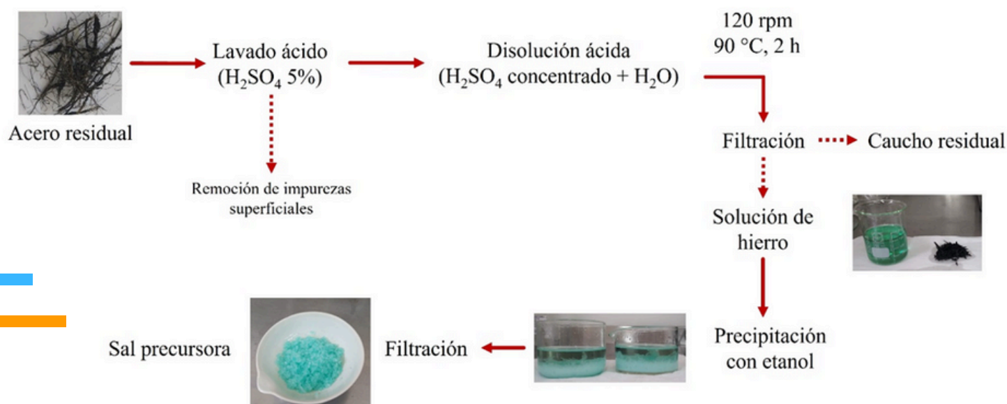
Figura 4. Esquema de síntesis de sulfato de hierro a partir alambres de llantas de desecho.
