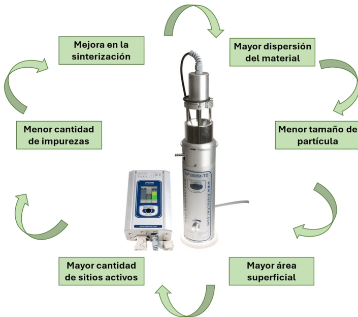
Fig. 3. Ventajas de la modificación de los residuos de bauxita con homogeneización ultrasónica.
