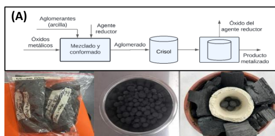
Figura 1. (A) Esquema conceptual del proceso. (B) Polvos catódicos obtenidos de baterías Li-ion. (C) Pellets autoreductores después de la etapa de secado. (D) Montaje de pellets en horno tipo mufla.
