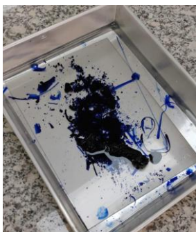
Figura 1. Frita pigmentada en su estructura amorfa.
